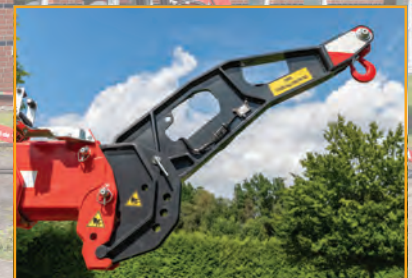
Montagespitze am Grundmast mit 1,2 to Tragfähigkeit
