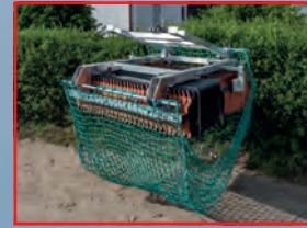
Dachziegelzange (Alu) - ein- bis zweireihig inkl. Sicherheitsnetz
